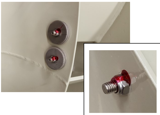
Bild: Prinzipdarstellung: Sicherung der Wuchtgewichte durch farblich erkennbaren Siegelack (Loctite SF 7400, oder SF 7240 Schraubensicherungslack)
